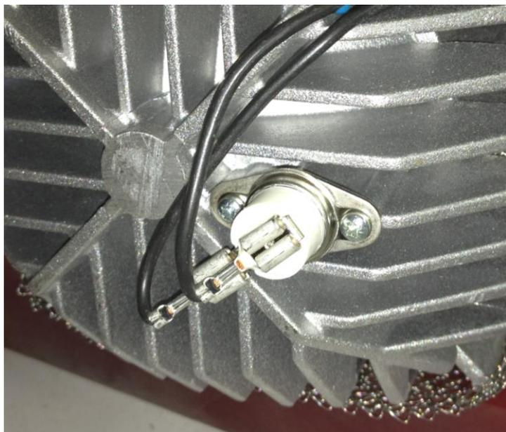
Рис.7 – Датчик перегрева
