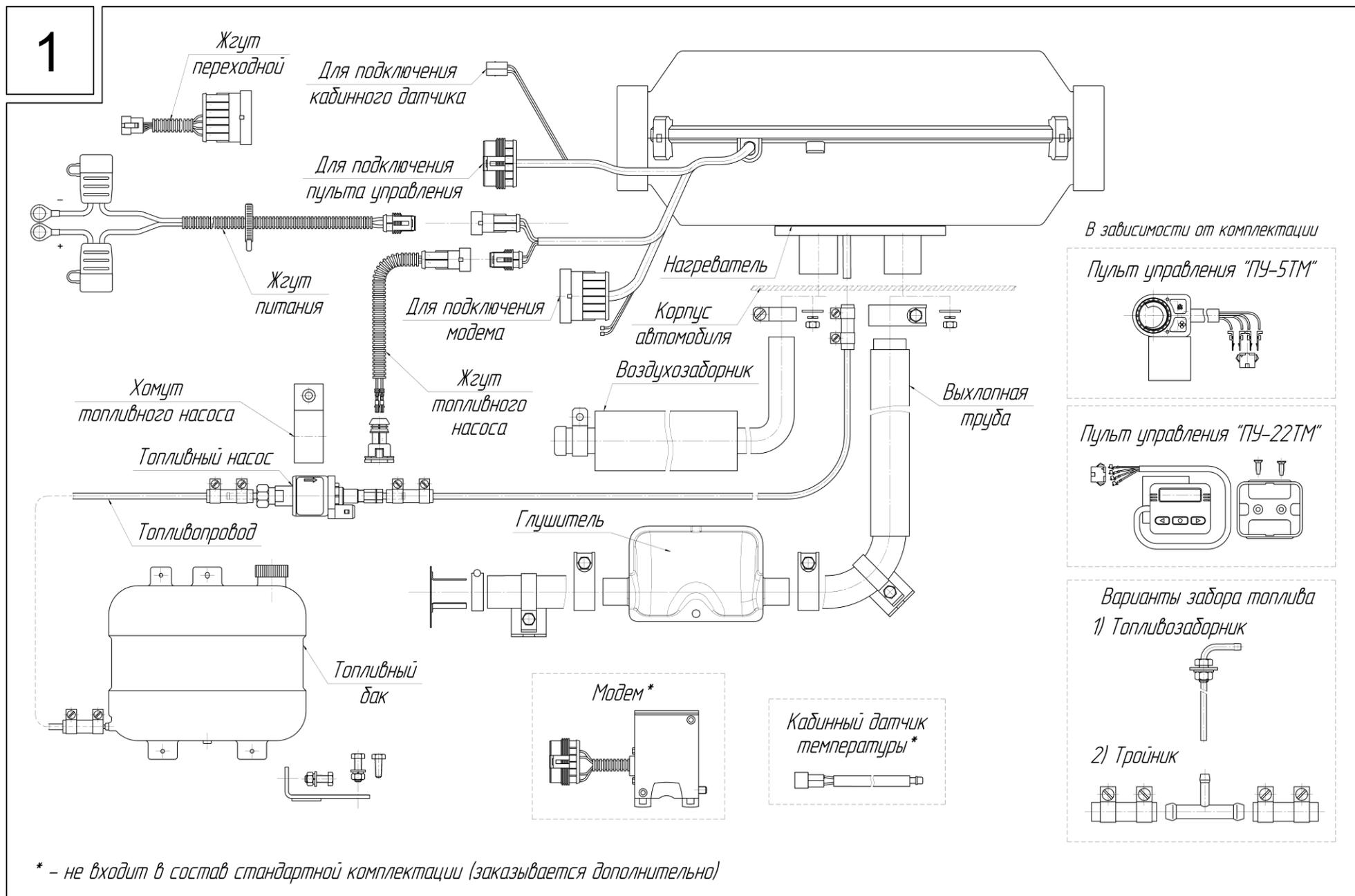
Схема соединений основных узлов и деталей отопителей PLANAR-4DM2 исполнения «Р»
