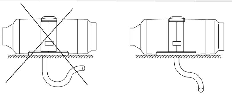
Выход отработанных газов и вход воздуха для горения должны быть расположены так, чтобы исключить возможность повторного забора отработанных газов
