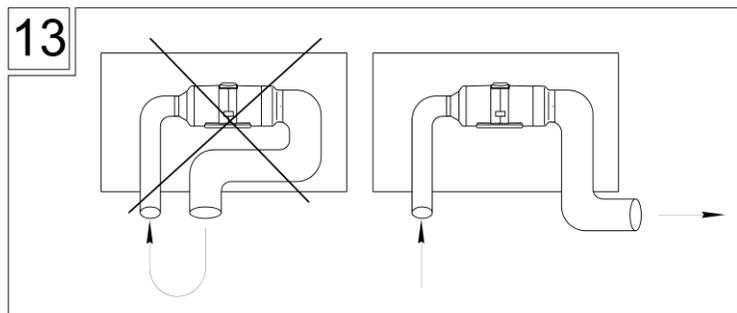
При использовании монтажного ящика срез патрубка подачи нагретого воздуха располагать так, чтобы горячий воздух не попадал в ящик.
