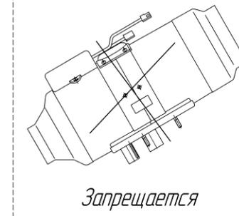
\* - Вид на отопитель со стороны входа нагреваемого воздуха (со стороны вентилятора).
