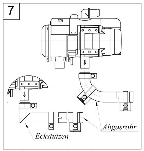
Das Abgasrohr muss mit einer Neigung nach unten vom Zuheizer verlegt werden. Falls möglich, muss am untersten Teil eine Öffnung von 3 mm Durchmesser für den Abfluss von Kondensat angebracht werden.
