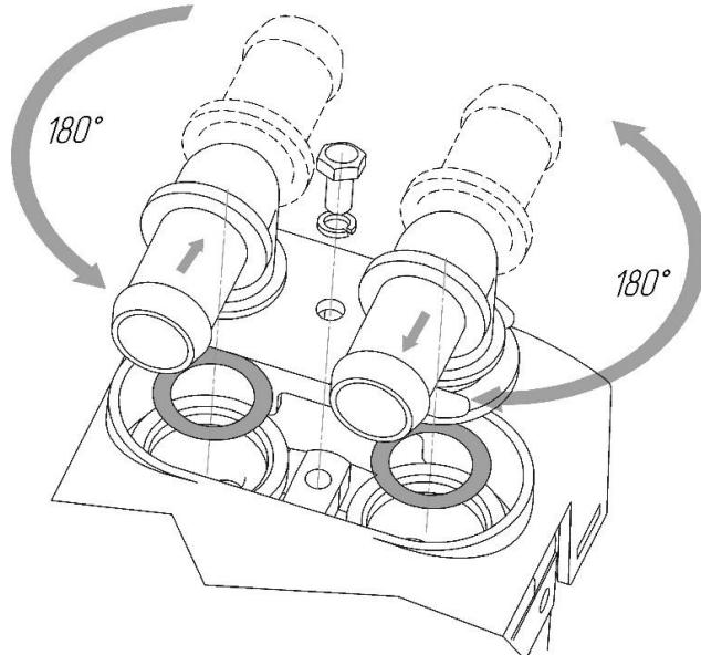
**Допускается** замена угловых патрубков на прямые (поставляются при дополнительном заказе).
