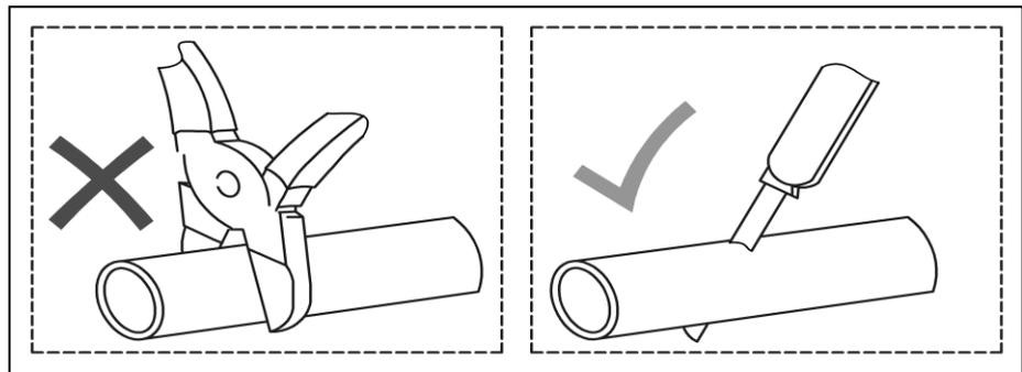
Fig. 21 - Découpe de la ligne avant l'installation.
