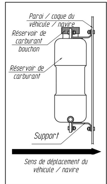
**Fig. 16 Installation du réservoir de carburant**
