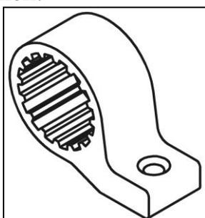
Abb. 24 - Flexible Gummiklemme
